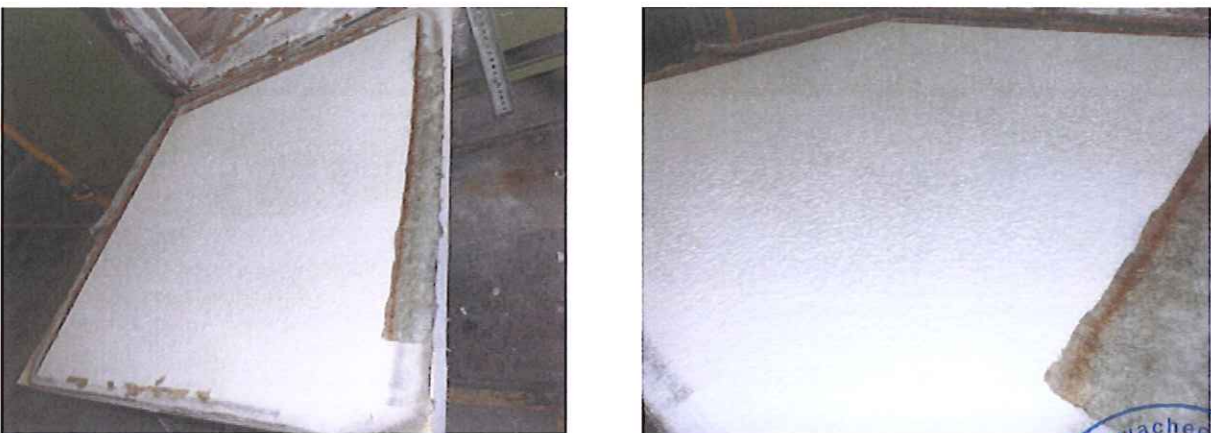
Abbildung 5.3: Probekörper nach der Brandprüfung – Ansicht der beflamten Seite
