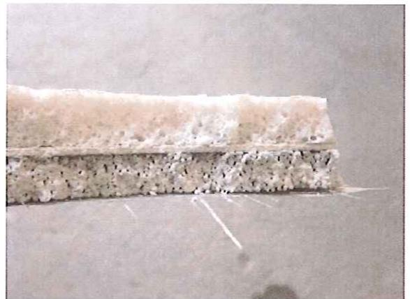
Abbildung 6.1: Probekörper nach der Brandprüfung
