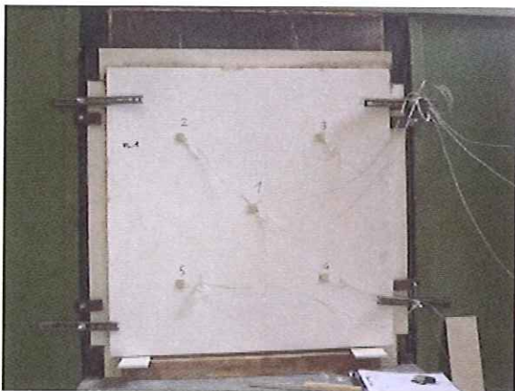
Abbildung 5.2: Probekörper während der Brandprüfung
